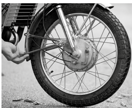
De beugel van het voorspatbord heeft een andere kromming.
