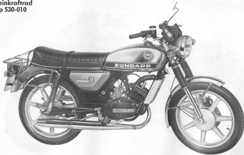
Bild 3 KS 50 watercooled mit wassergekühltem Motor, 4,6 kW (6,25 PS), 5 Gänge, Super-Cockpit mit elektronischem Drehzahlmesser und Tachometer, Elektronik-Zündung, 4fach-Blinkanlage, Scheibenbremse vorn, gedämpfte Telegabel
