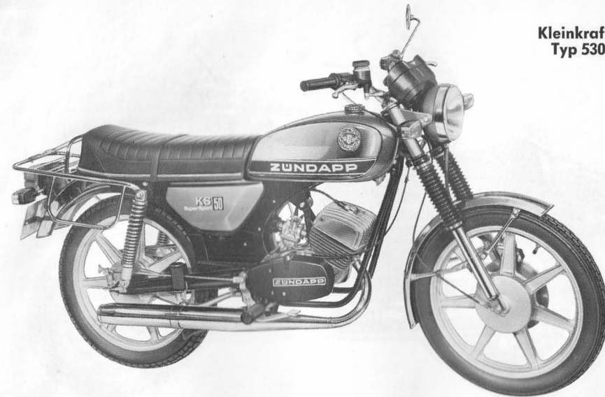
Bild 2 KS 50 SuperSport mit fahrtwindgekühltem Motor, 4,6 kW (6,25 PS), 5 Gänge, Super-Cockpit mit elektronischem Drehzahlmesser und Tachometer, Elektronic-Zündung, 4fach-Blinkanlage, Scheibenbremse vorn, gedämpfte Telegabel
