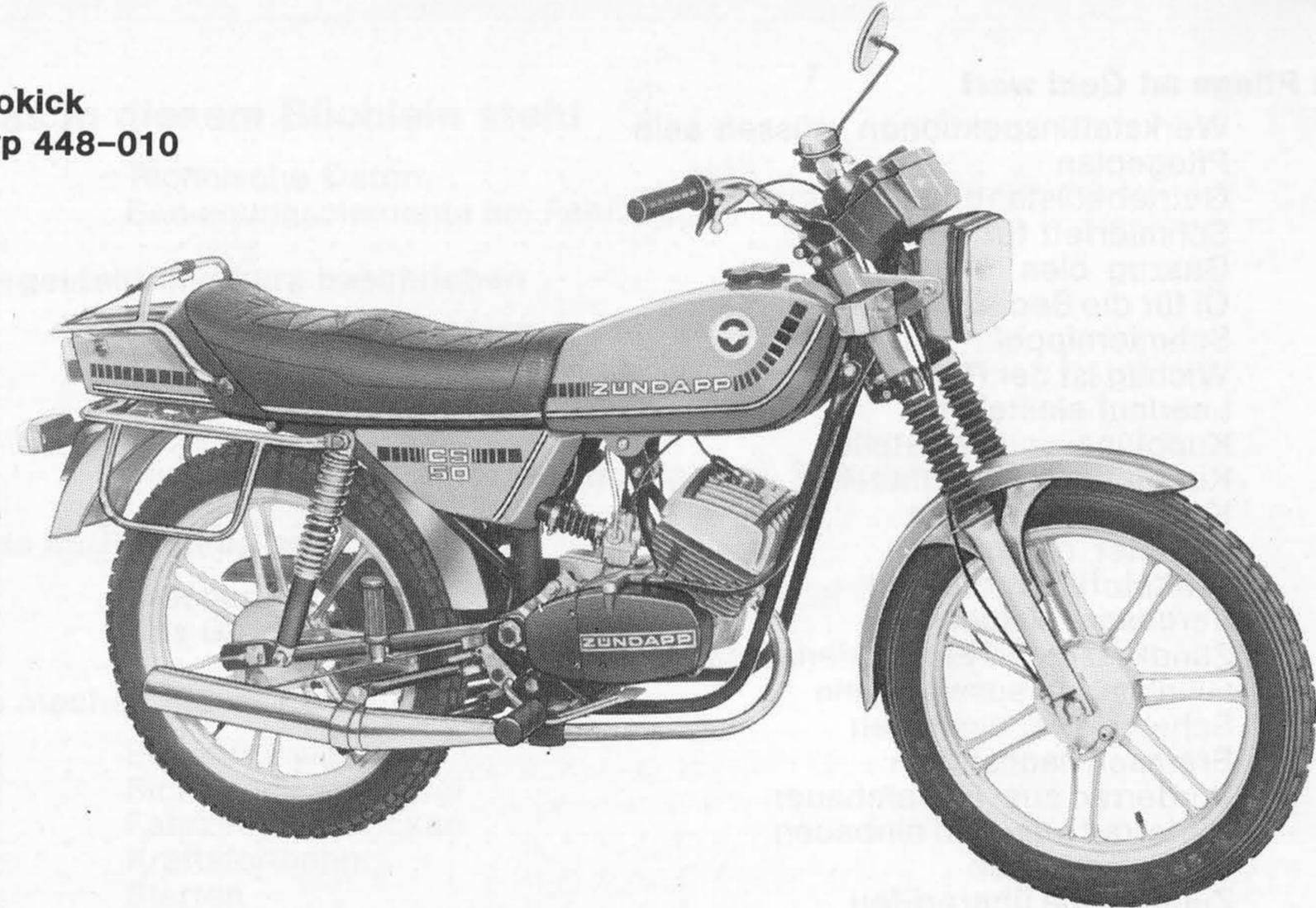
**CS 50 mit fahrtwindgekühltem Motor, 2,1 kW, 4 Gänge, Fußschaltung, Kickstarter, Cockpit mit Tachometer, 4fach-Blinkanlage, Heckspoiler, Gepäckträger (Packtaschen-träger als Sonderzubehör lieferbar)**
