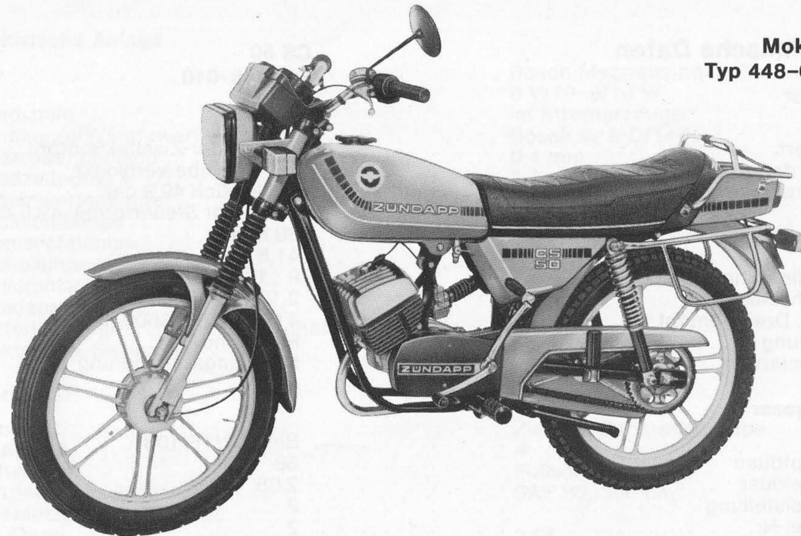
**CS 50 mit fahrtwindgekühltem Motor, 2,1 kW, 4 Gänge, Fußschaltung, Kickstarter, Cockpit mit Tachometer, 4fach-Blinkanlage, Heckspoiler, Gepäckträger (Packtaschen-träger als Sonderzubehör lieferbar)**
