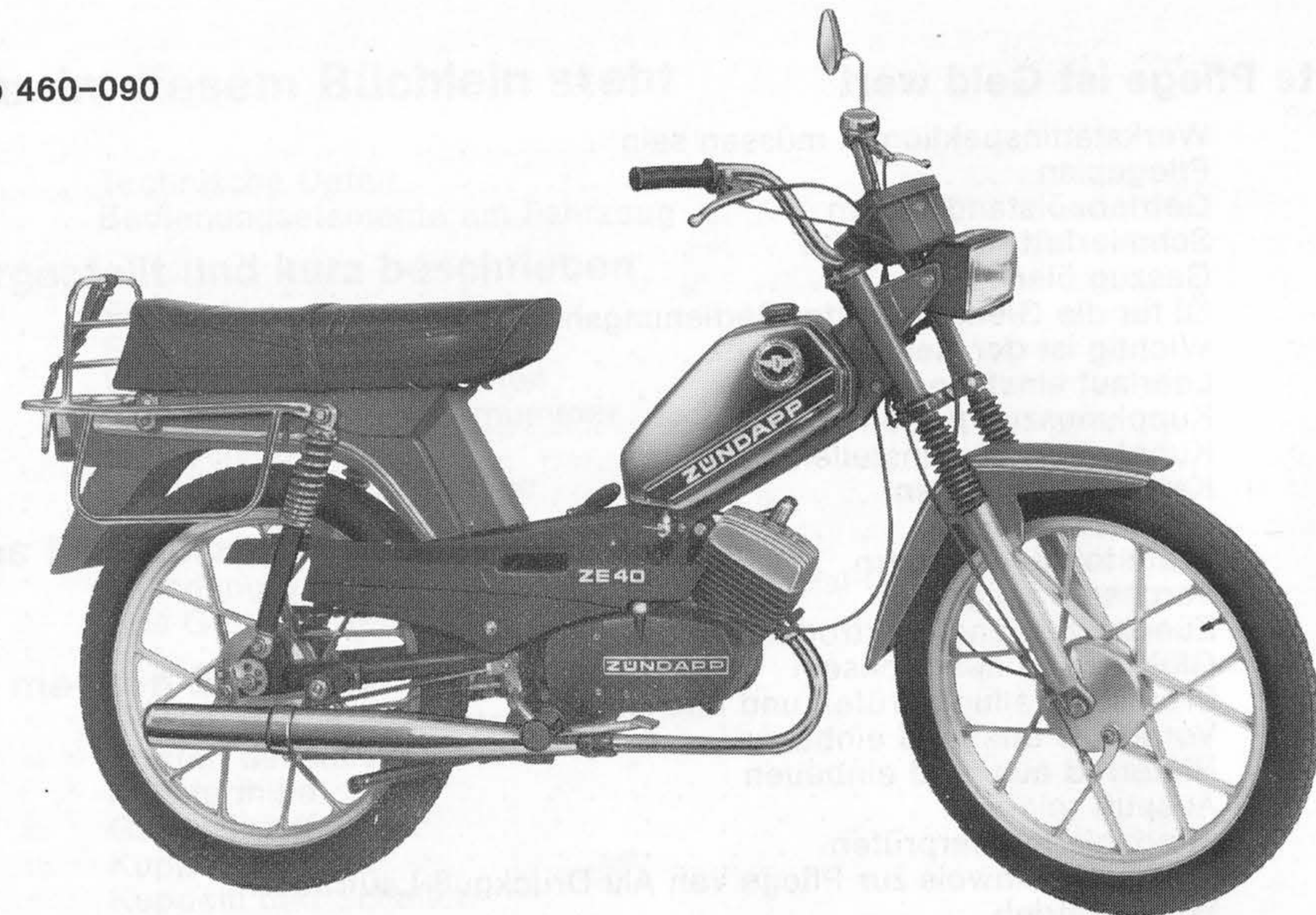
ZÜNDAPP-Mokick ZE 40, 40 km/h, 3 Gänge, Fußschaltung, Kickstarter, Cockpit mit Tachometer und Zündschloß, Doppel-Sitzbank, Packtaschen-/Gepäckträger
