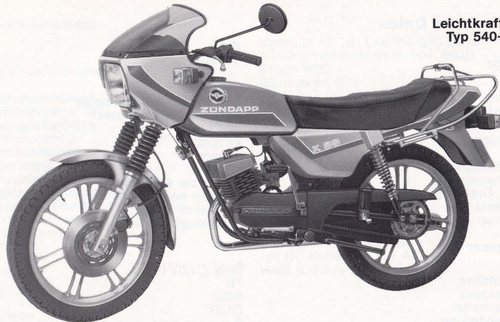
**K 80 mit luftgekühltem Motor, 6,1 kW, 5 Gänge, verkleidetes Cockpit mit Tachometer, Elektronik-Zündung, elektronischer Drehzahlmesser, 4fach-Blinkanlage, Scheibenbremse vorn, gedämpfte Telegabel vorn, 3fach verstellbare Federbeine hinten, Heckspoiler, Gepäckträger mit Packtaschen-Halterungen**
