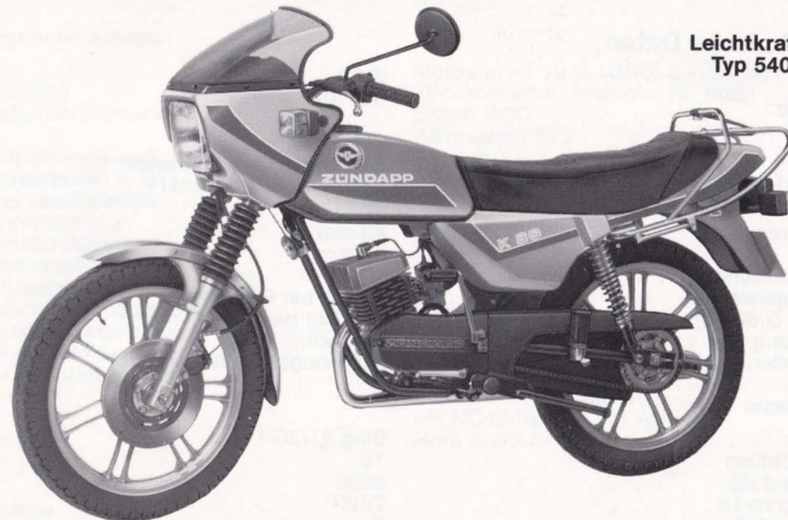
**K 80 mit luftgekühltem Motor, 6,1 kW, 5 Gänge, verkleidetes Cockpit mit Tachometer, Elektronik-Zündung, elektronischer Drehzahlmesser, 4fach-Blinkanlage, Scheibenbremse vorn, gedämpfte Telegabel vorn, 3fach verstellbare Federbeine hinten, Heckspoiler, Gepäckträger mit Packtaschen-Halterungen**
