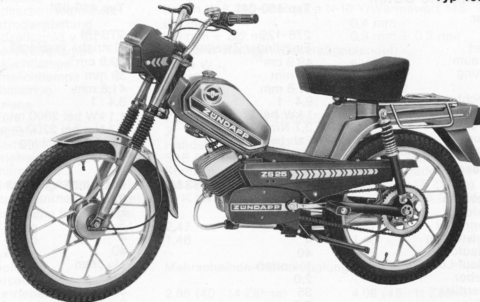
**ZÜNDAPP-Mofa ZS 25, 25 km/h, 1,1 kW, 3 Gänge, Handschaltung, Pedal-Kickstart, Cockpit mit Tachometer und Zündschloß, Einzel-Sitzbank, Packtaschenträger**
