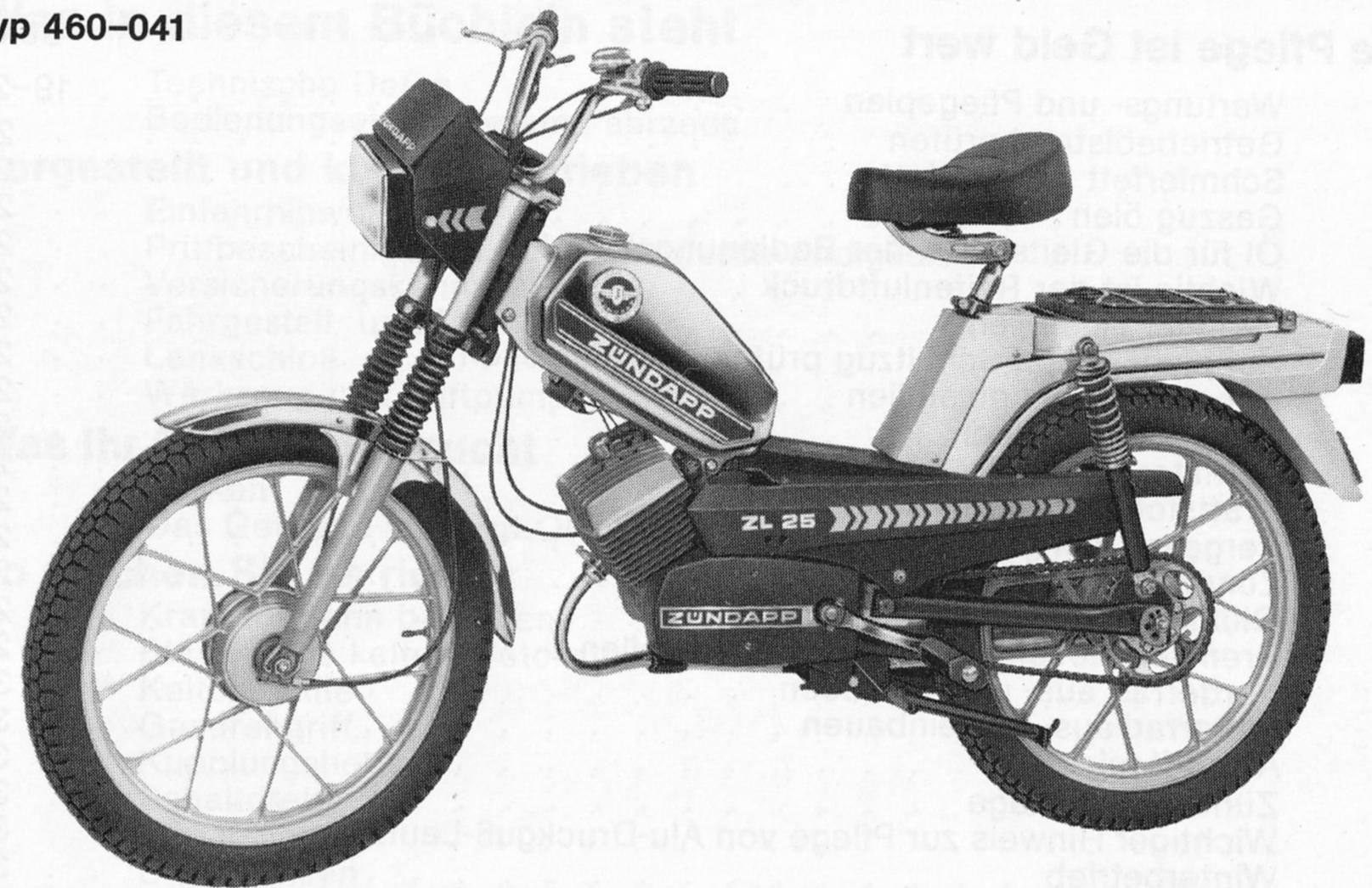
**ZÜNDAPP-Mofa ZL 25, 25 km/h, 1 kW, 2 Gänge, Handschaltung, Pedal-Kickstart, Cockpit mit Tachometer und Zündschloß**
