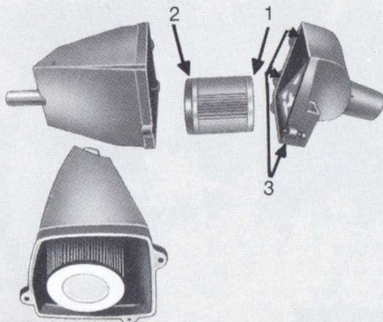
Staub von der Filterpatrone entfernen. Die Filterpatrone darf nur trocken gereinigt werden und nicht mit Flüssigkeiten in Berührung kommen! Bei starker Verschmutzung Filterpatrone durch neue ersetzen! Bei Montage auf richtige Lage der Filterpatrone und des Dichtringes (14/2) im Gehäuse achten.
