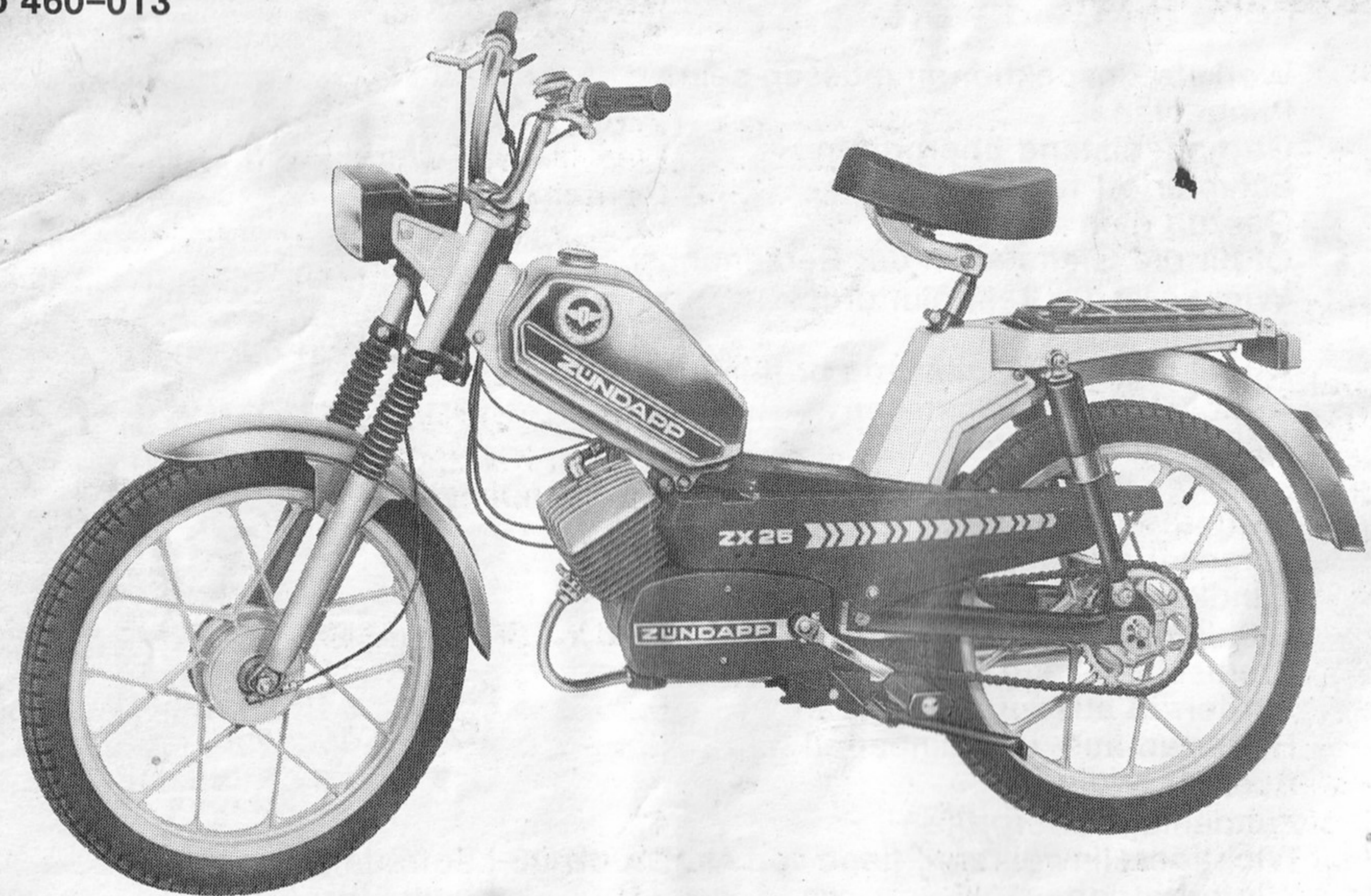
ZÜNDAPP-Mofa ZX 25, 25 km/h, 1 kW, 2 Gänge, Handschaltung, Pedal-Kickstart
