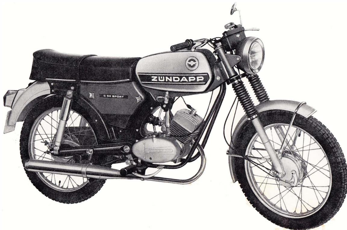
**40 km/h, 2,9 PS, 3 Gänge, Fußschaltung, Schleifenunterzüge, Einzel-Super-Cockpit**
