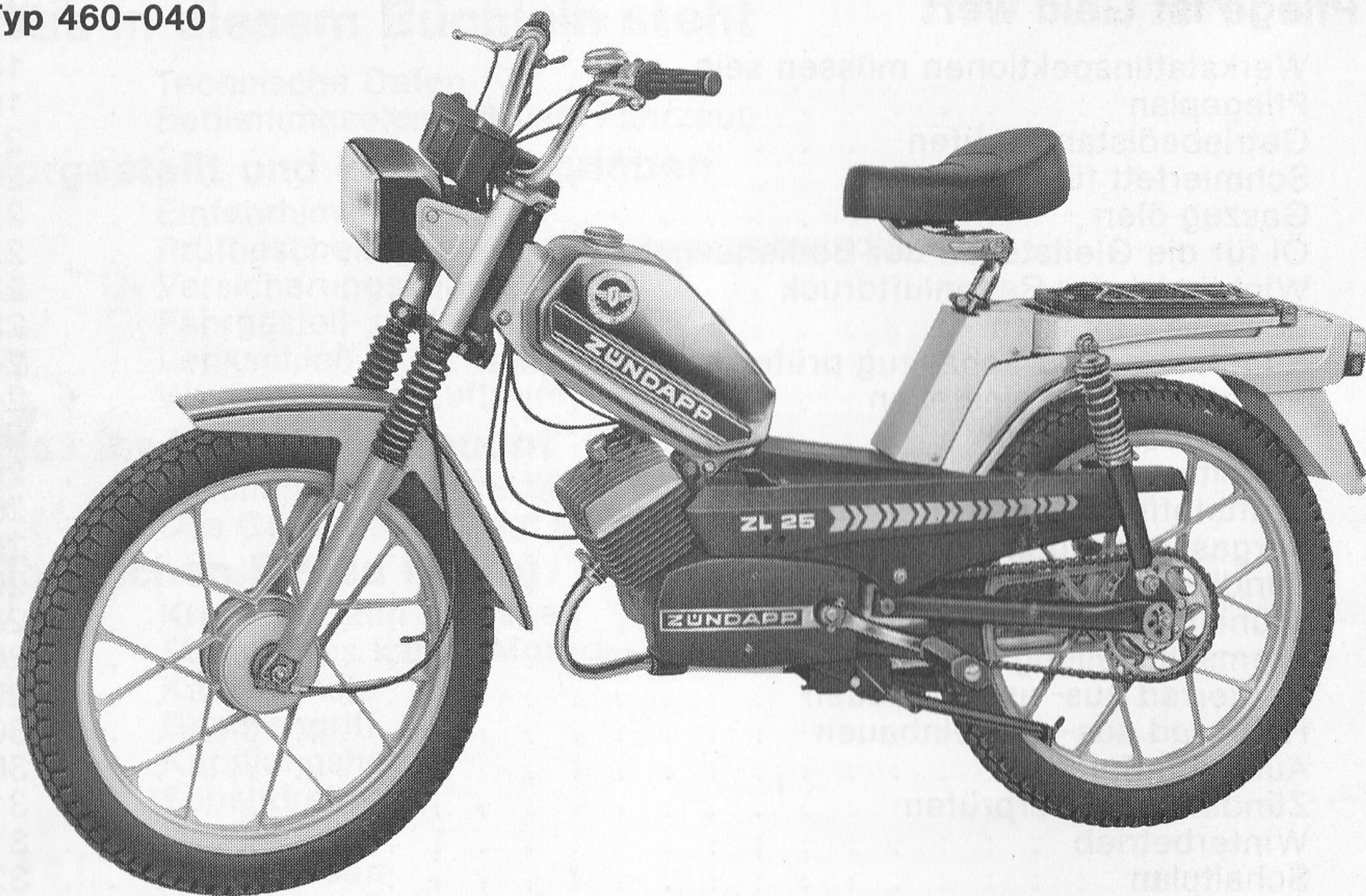
ZÜNDAPP-Mofa ZL 25, 25 km/h, 1 kW, 2 Gänge, Handschaltung, Pedal-Kickstart
