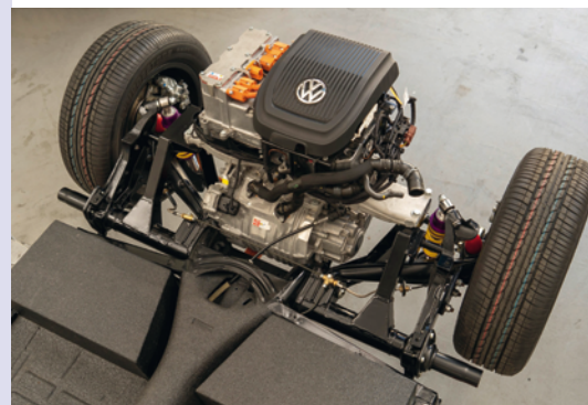
Achterin luchtgekoeld telt niet meer voor dit Kever onderstel
