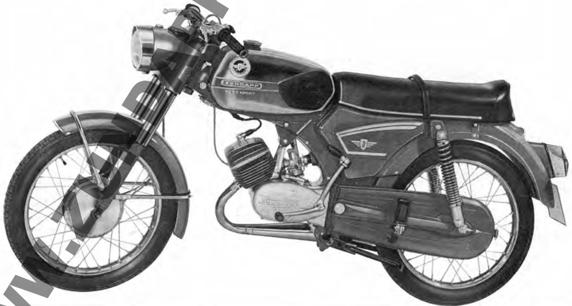
KS 50 Sport mit Fächerkopf-Zylinder, 5 Gänge, Fußschaltung, Kickstarter, Sport-Federbeine, Sport-Lenker, Sport-Sitzbank
